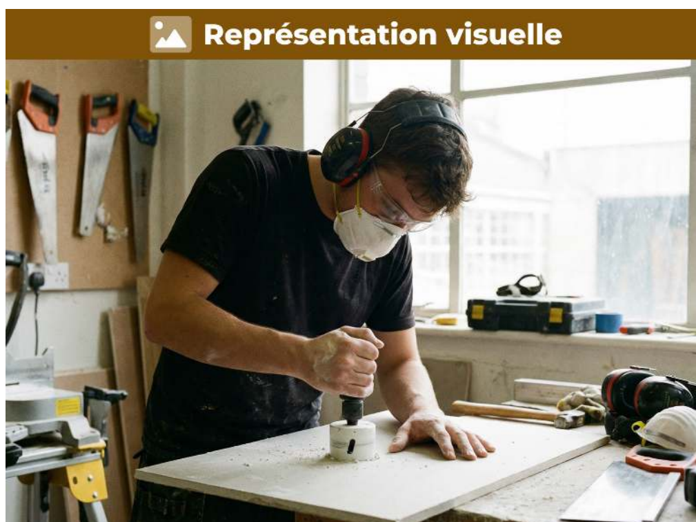
Découpe précise des plaques de plâtre avec une scie à cloche pour un ajustement parfait
